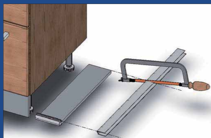
Figura 03. Tagliare a misura il profilo compensatore come indicato. Cut plinth compensator profile as shown in the figure.
