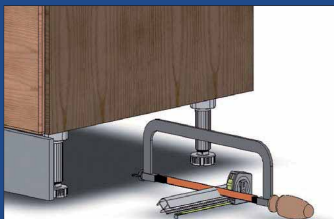
Figura 02. Tagliare il profilo angolo all'altezza misurata. Cut corner profile to measured height.
