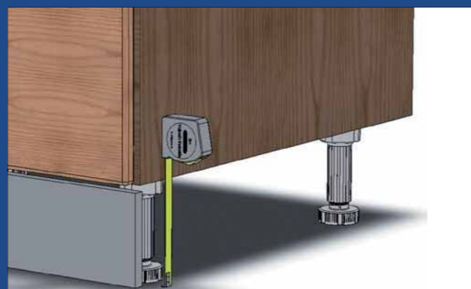
Figura 01. Misurare l'altezza della base pavimento vicino al piede interessato all'angolo. Measure the distance between floor and base of the furniture nearest corner.
